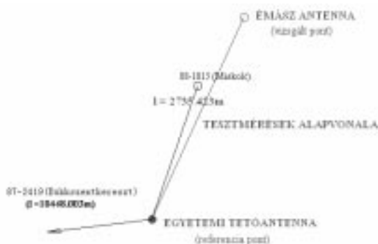
2. ábra: A tesztalapvonal és az egyetemi tetőantenna bemérése
