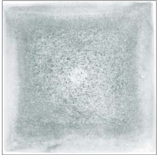
■ 5. ÁBRA. 38MnSiVS 5 minőségű, kénnel mikroötvözött, 180x180 mm méretű, folyamatosan öntött buga makrosziszolatáról készült Baumann-lenyomat
