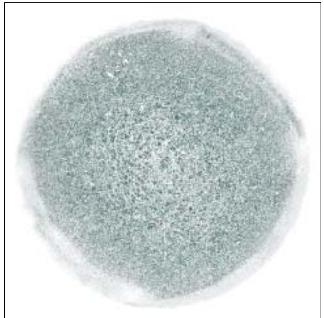
■ 6. ÁBRA. Hengerelt köracél Baumann-lenyomata
