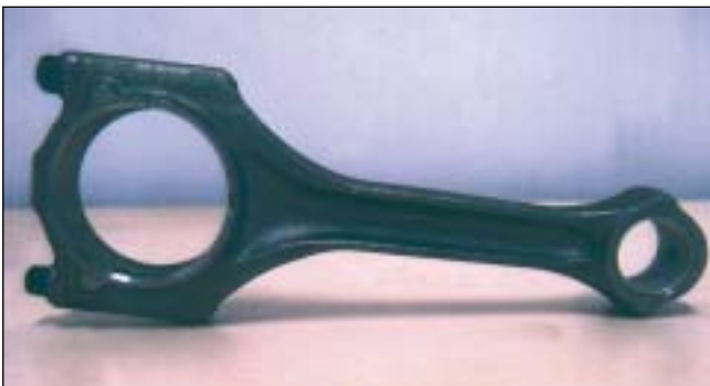
■ 8. ÁBRA. Kénötvözésű dugattyúmozgató hajtókar
