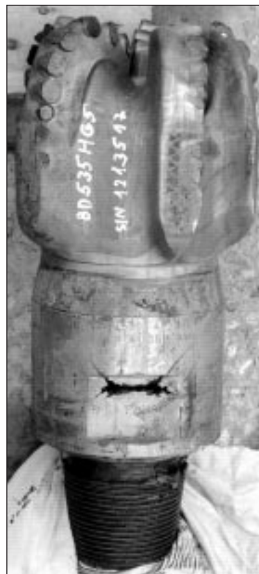
14. ábra: Egy kiépített PDC fúró elhasznált fúró, amelyet 0-val jelölnek.
