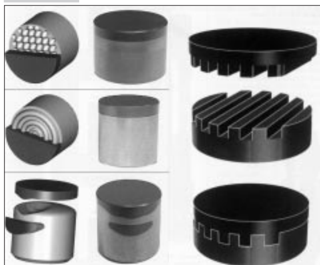
6. ábra: Mesterségesgyémánt lapok felerősítése a wolframkarbid alapra
