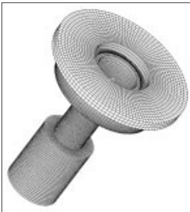
8. ábra: A szelep végleges geometriai modellje és cellastruktúrája
