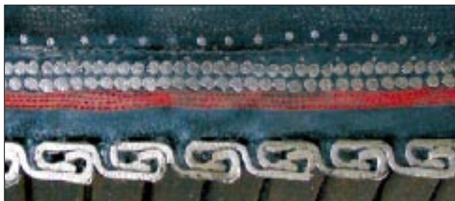
3. kép: 15” (386 mm) termelő tömlő metszete több mint 10 évi északi-tengeri üzemeltetést követően
