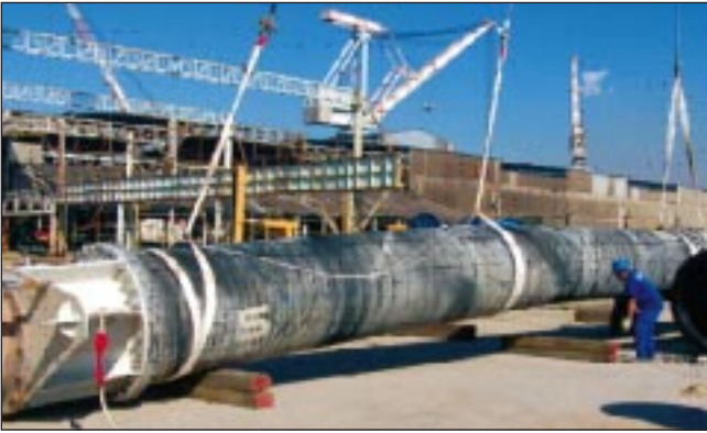
6. kép: A Barracuda mezőről (Brazília) ellenőrzésre kivett, 1000 mm-t meghaladó belső átmérőjű vízkiemelő tömlővonal
