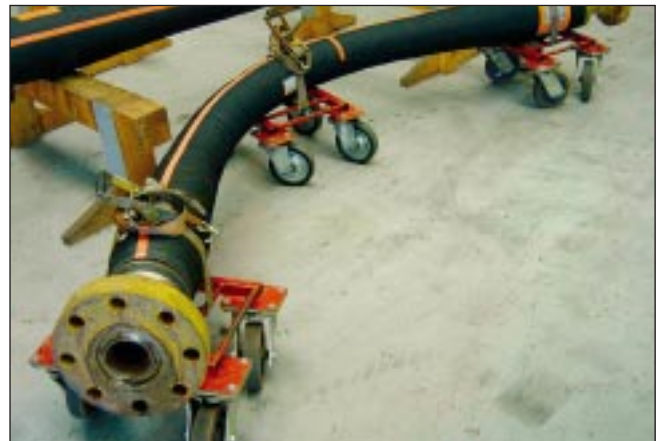
7. kép: TauroBend előformázott 3" (76 mm) 103,4 MPa (15 000 psi) kötött szerkezetű elfojtó és kitérésátló tömlő 121°C üzemi hőmérsékletre és 36 MPa-t meghaladó külső nyomásra
