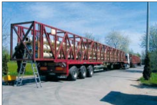
2. kép: Nagynyomású termelő riser szállításra előkészítve. Teljes hossz 700 m, tervezési nyomás 20,7 MPa (3000 psi), belső átmérete 6" (152 mm)
